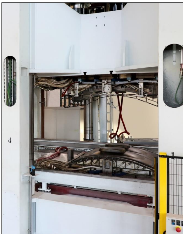
Produktionsline, eingerichtet für Seitenwand-Formversuche (Foto: Cannon Group)
