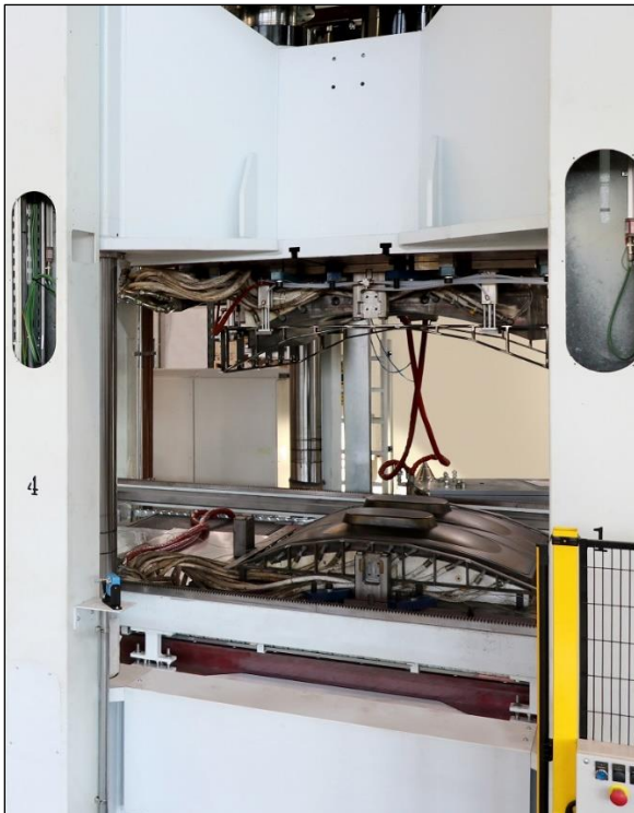
Linea di produzione, configurazione per le prove di stampaggio delle pareti laterali (Foto: Cannon Group)
